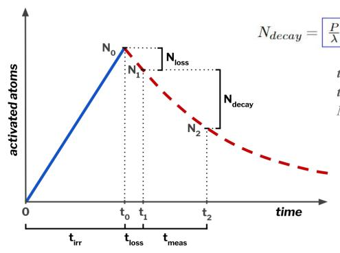
$$N_{decay} = \begin{bmatrix} \frac{P}{\lambda} (1 - e^{-\lambda t_{irr}}) \end{bmatrix} \begin{bmatrix} e^{-\lambda t_{loss}} \\ e^{-\lambda t_{loss}} \end{bmatrix} (1 - e^{-\lambda t_{meas}})$$
